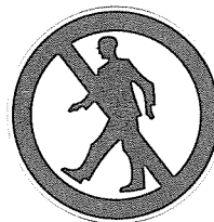
Bild 1: "Für Fußgänger verboten" Sicherheitszeichen DIN 4844-V3
