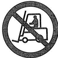
Bild 4: "Für Flurförderzeuge verboten" Sicherheitszeichen DIN 4844-V7
